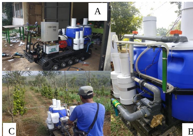
Gambar 23. Visualisasi kegiatan perakitan robot fertigasi (A, B), dan aktivitas aplikasinya pada pemberian perlakuan irigasi dan fertigasi di lapangan (C)
