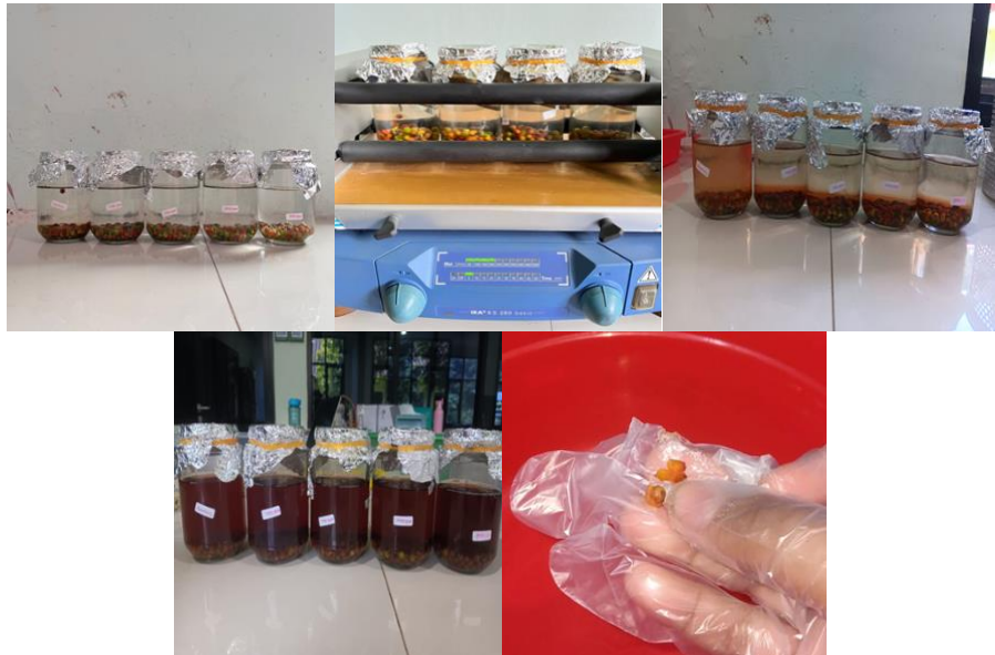
Gambar 25. Tahapan pengujian perendaman lada menggunakan enzim pektinase
